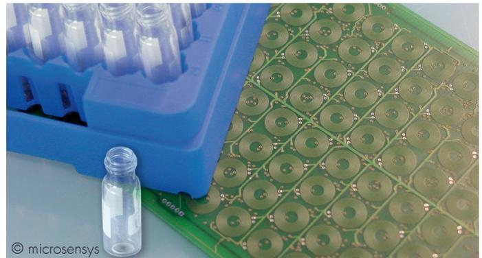
Dazu werden am Boden der Proben kleine Transponder angebracht. Die dabei verwendeten Transponder können über eine Speicherkapazität von bis zu 32kBit verfügen und sind mit speziellem Packaging auch sterilisationfest. Jeder Transponder verfügt über eine UID Nummer (Unique Identifier), die als Basiserkennung für eine Datenbank genutzt werden kann.
