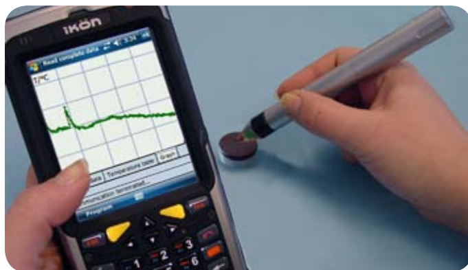
Mobile Temperaturüberwachung mit dem Ikön von Psion Teklogix, dem iID PEN bt reader und dem TELID311 RFID-Sensor-Datenlogger
