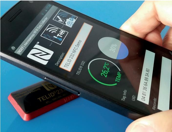
Die Integration von NFC (Near Field Communication) in eine Vielzahl mobiler Endgeräte öffnet die Tür für neue Applikationen. Dabei stützt sich NFC auf bestehende RFID-Normen (ISO14443) und ergänzt diese um standardisierte Datenformate für Massenanwendungen. Kleine Identifikations- und Sensorik-Anwendungen können unkompliziert realisiert werden, da die Lese-Infrastruktur durch Smartphones etc. vorliegt.
