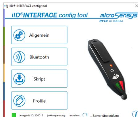
Hier sehen Sie eine Abbildung des angeschlossenen RFID-Interface sowie die Buttons zur Auswahl der jeweiligen funktionellen Parameter. Bei Auswahl eines Menüpunktes werden die jeweils aktuellen Parameter vom RFID-Interface an die Software übertragen.
